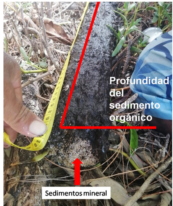
Figura 1.2 Núcleo de sedimento de manglar. Muestra el tipo de barreno abierto del tipo ruso, así como la profundidad total del sedimento orgánico la que es determinada por la longitud del núcleo con sedimento oscuro y la capa de arena coralina al extremo marginal del barreno.
