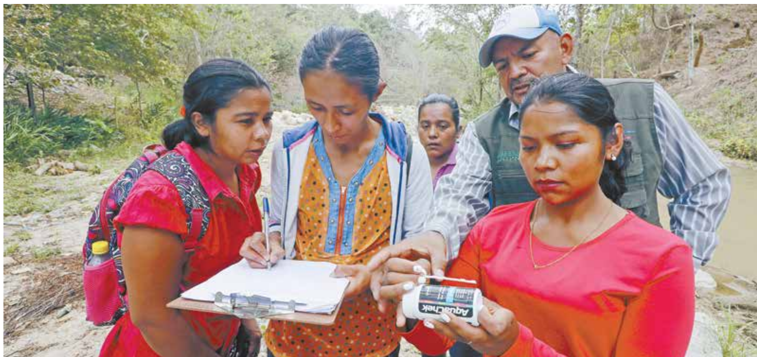
Momento en que comparan las cintas reveladoras para determinar la presencia de algunos elementos nocivos en el agua del Río Dipilto.
