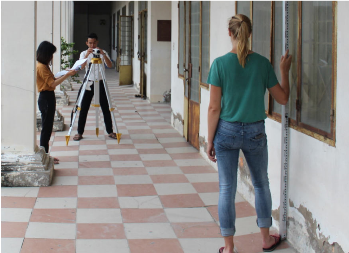
Hình 3: Đo chênh cao bằng máy kinh vĩ tại các tòa nhà tại ĐBSCL – GIZ phối hợp với Trường ĐH Utrecht và ĐH Cần Thơ (Ảnh: Kim de Wit)
