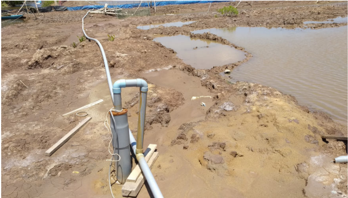
Hình 20: Bơm nước để phục vụ nuôi tôm tại Bạc Liêu (Ảnh: Sophie Krüger)
