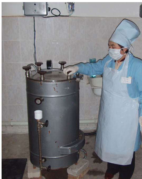
In Autoklaven wird Abfall unter Hochdruck desinfiziert.
