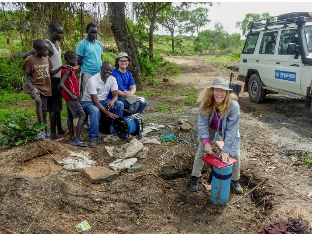
Ellen Milnes, Hydrogeologin und Teil des Schweizerischen Korps für humanitäre Hilfe, inspiziert mittels Kamera ein neues Bohrloch. Vom Bohrer herausgebrochenes Gestein (links) wird nach Bohrtiefe sortiert. Geologen können dadurch die Bodenbeschaffenheit charakterisieren.
