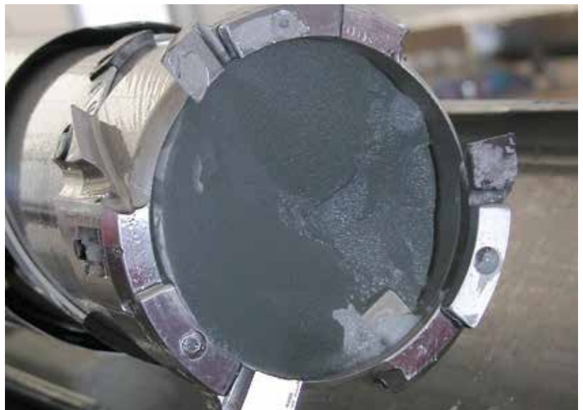
Bohrkopf mit einem Eisbohrkern von 10 cm Durchmesser von der Station Dome C, Antarktis © Jakob Schwander, Universität Bern
