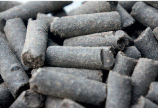
In grossen Trockenbeeten wird der Fäkalschlamm getrocknet. Anschliessend werden aus dem Wertstoff Dünger, Pellets oder andere Formen von Brennstoff produziert und an die Industrie verkauft.
