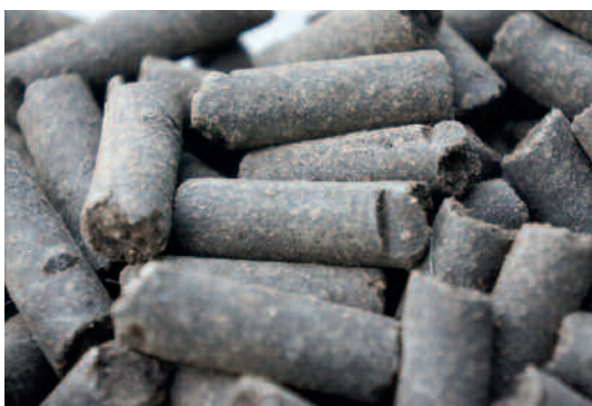
Il fango fecale essiccato viene trasformato in combustibile e venduto alle industrie per la produzione di cemento e di altri materiali di costruzione.
